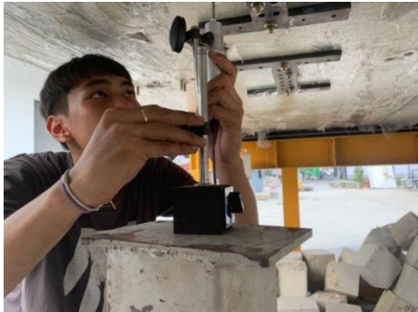
รูปที่ 10 การติดตั้ง LVDT
