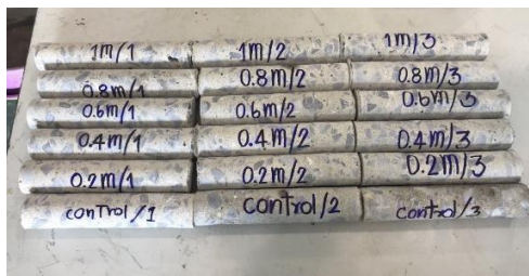
รูปที่ 4 แท่งตัวอย่างคอนกรีตที่คว้านเจาะ (Coring) ทุก ๆ 20 เซนติเมตร
