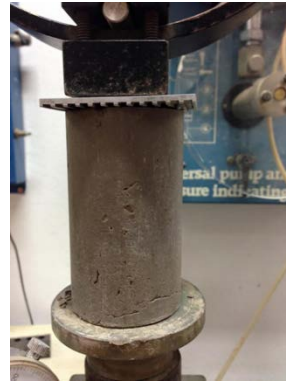
รูปที่ 5 ทดสอบกำลังรับแรงอัดแบบไม่ถูกจำกัด
