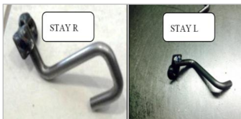
ภาพที่ 2 ตัวยึดชุดสรีรจักรยานยนต์ (STAY R-L) ที่เสร็จสมบูรณ์
