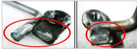
ภาพที่ 4 แนวเชื่อมไม่ซึมลึก
